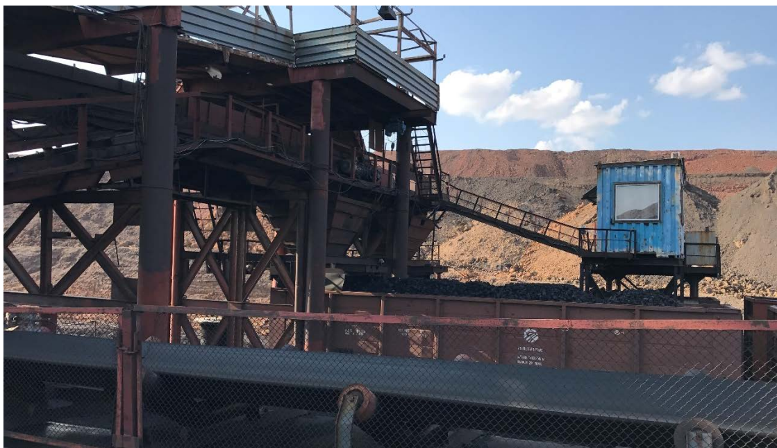
Рис. 6-1: Установка дробления/сортировки и выгрузки угля на участке Центральный – погрузка сортировочного угля с участка Центральный в вагонетки
