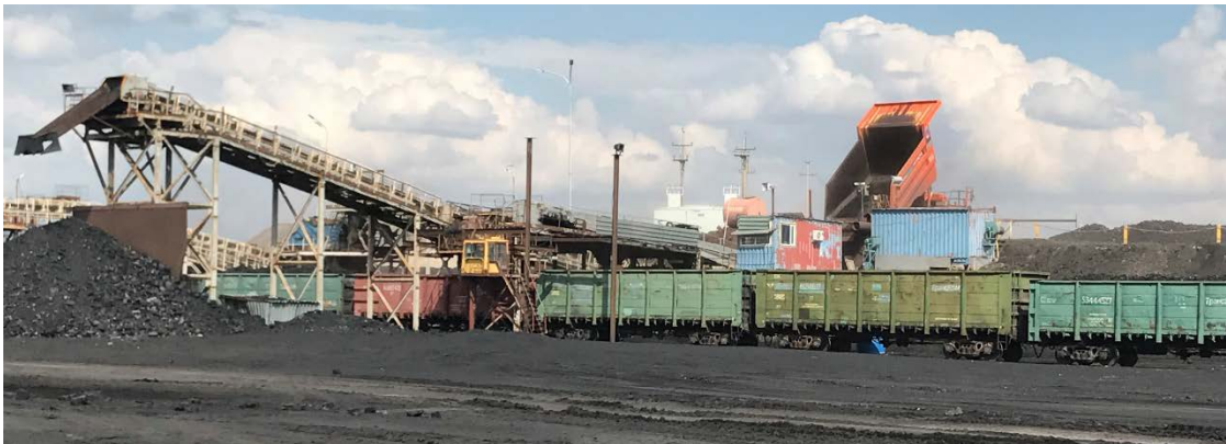
Рис. 6-2: Установка дробления/сортировки и выгрузки угля на участке Западный – прямая погрузка угля с участка Западный в вагонетки по конвейеру №1
